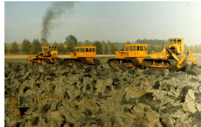
Abb. 347-02: Anlage der Sandmischkultur mit Raupenfahrzeugen (DTK 25 Blatt 3309 Meppen), Foto: W. SCHÄFER 1986
